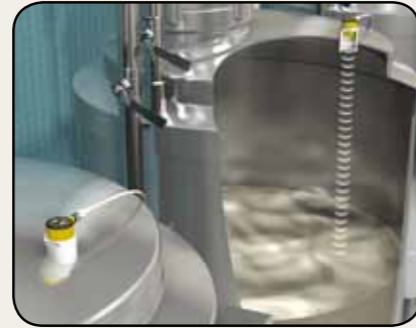
量測桶槽內的液位高度
