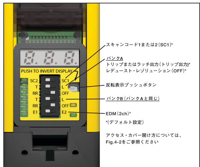
Fig.4-1 EZスクリーンの設定スイッチ(受光器)
