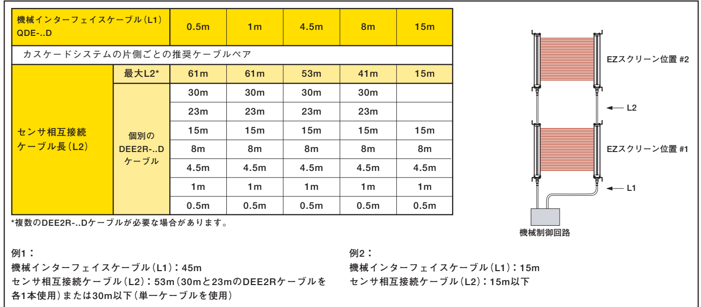
Fig.7-2 2つのカスケード・ライトスクリーンのケーブル長オプション
